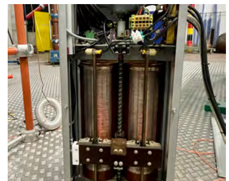
Abbildung 3: Stelltransformator mit Absolutwertgeber
