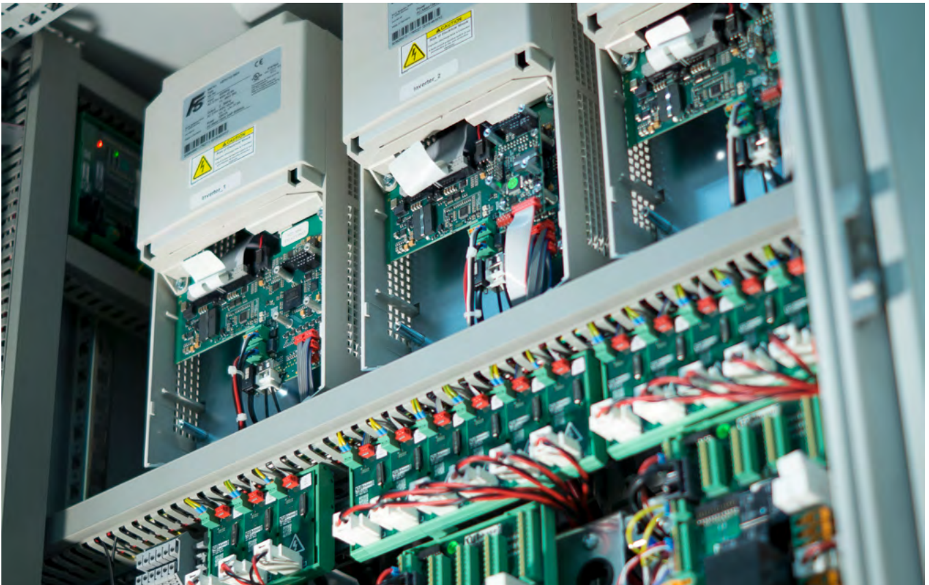
Abbildung 3: Vollprogrammierbarer dreiphasiger Prototypenstromrichter
