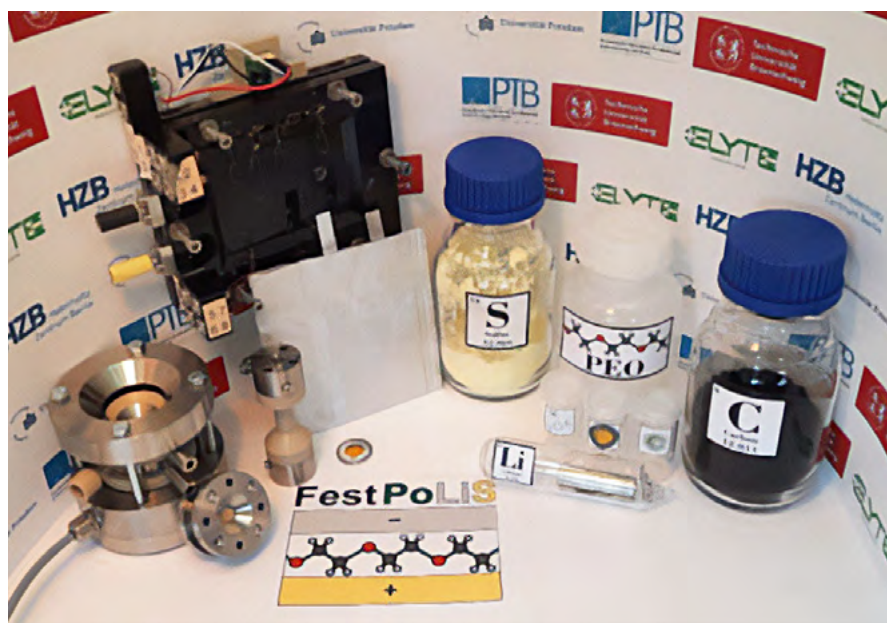
Abbildung 2: Materialien in einer Lithium-Schwefel-Batterie
