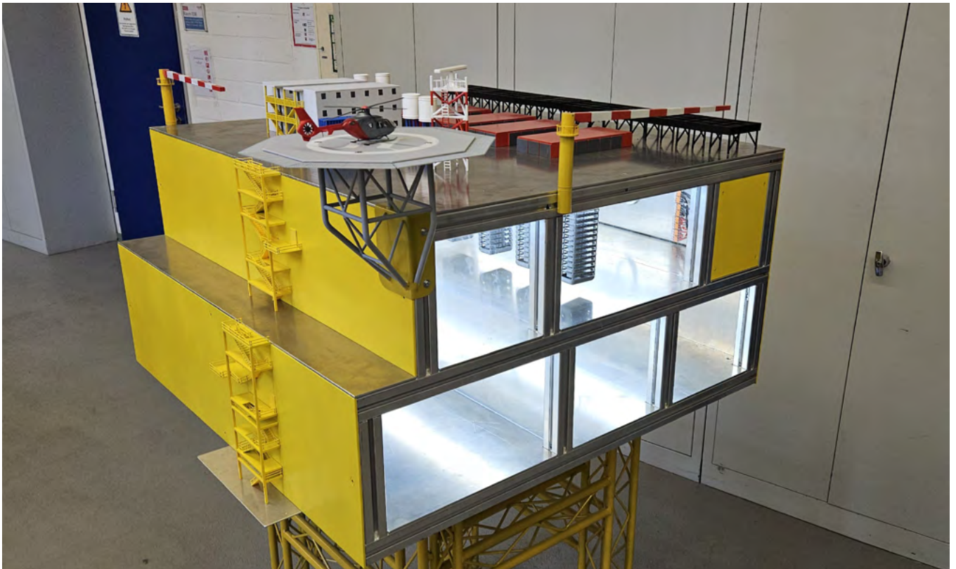
Abbildung 2: HVDC Offshore Plattform
