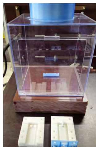
Abbildung 5: Schaltkammer mit Abzug für Materialuntersuchungen
