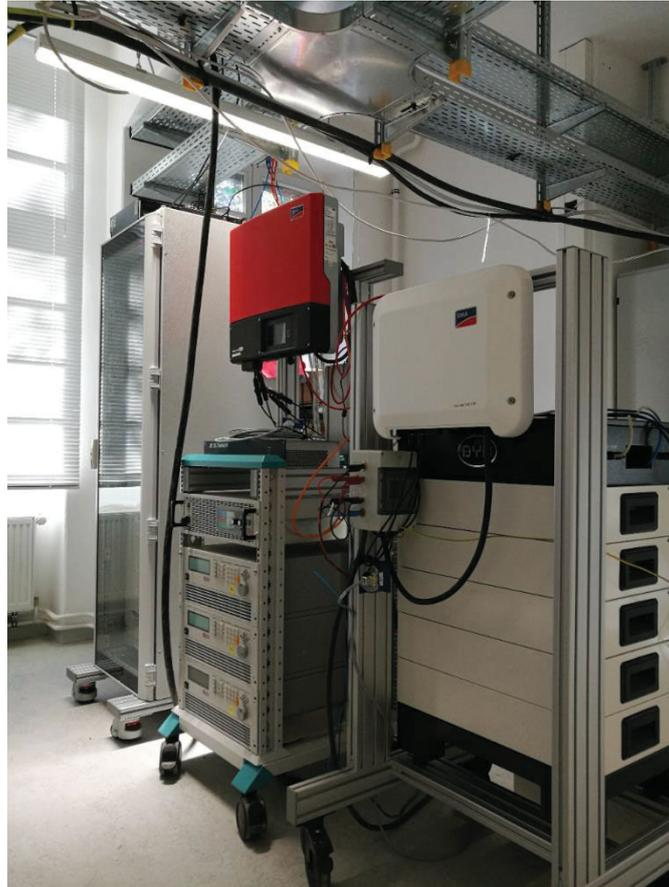
Abbildung 16: Vermessung eines PV-Speichersystems nach Effizienzleitfaden
