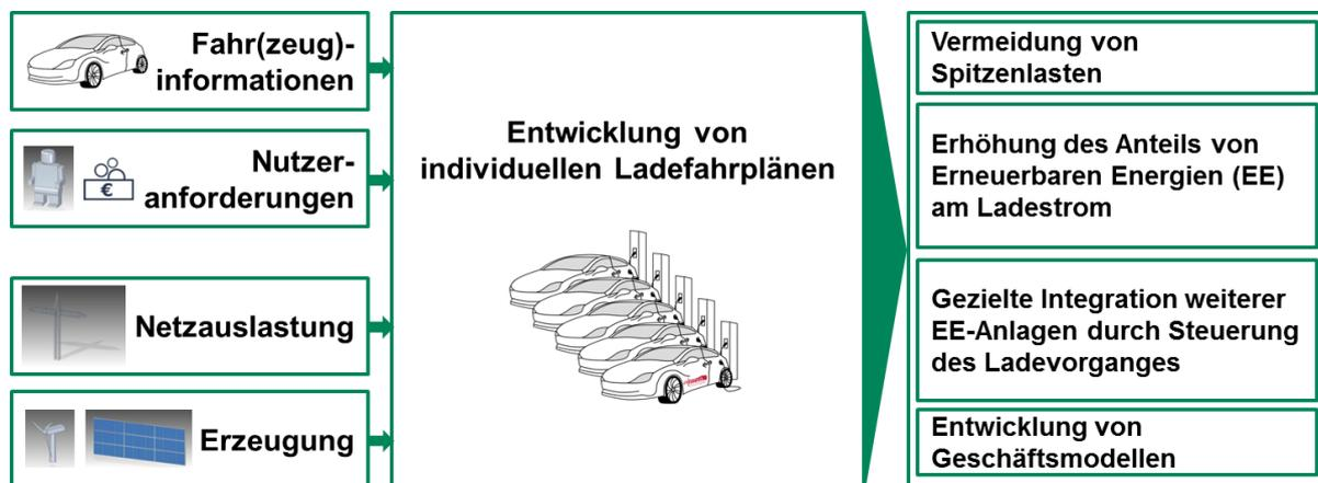
Abbildung 17: Entwicklung individueller Ladefahrpläne unter Berücksichtigung der Restriktionen von Nutzer, Fahrzeug, Netz und Erzeugung.
