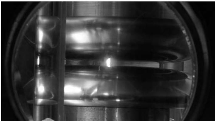
Abbildung 1: Entladung im flüssigen Stickstoff
