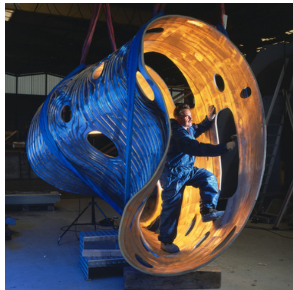
Abbildung 3: Teil des Plasmagefäßes vom W7-X während der Fertigung[5]
