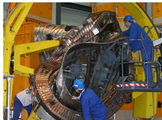
Nicht-planare Spule: ○ Gewicht: 6 t ○ Höhe: 3,5 m
