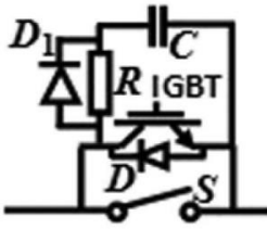
Bild 4 ZVS – Hybridschalter mit RCD - Dämpfung
