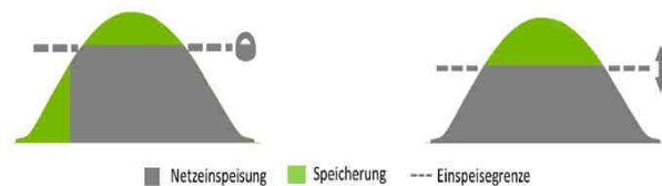
Abb 8: Prognosebasierter Betrieb mit fester Einspeisegrenze J. Weniger, J. Bergner, T. Tjaden, V. Quaschnig: „Bedeutung von prognosebasierten Betriebsstrategien für die Netzintegration von PV-Speichersystemen“ S.14, in 29. Symposium Photovoltaische Solarenergie, Bad Staffelstein, 2014.
