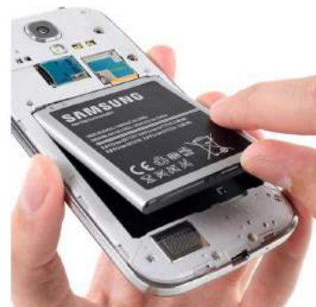
Abbildung 4: Li-Ionen-Akku als Pouch-Zelle [4]
