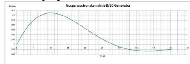
**Bild 4** Stromverlauf 8/20 Generator
