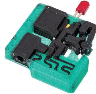
Abbildung 11: 3D-gedruckte Blinkschaltung mit integrierten Buchsen, Schalter, Widerständen und konventionellen Komponenten [2]
