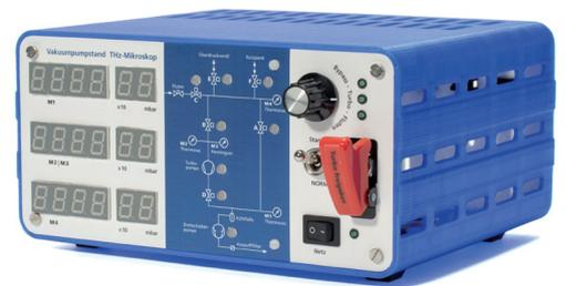
Abbildung 12: 3D-gedrucktes Gehäuse für eine Pumpensteuerung
