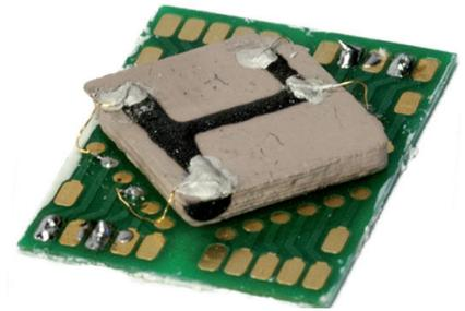
Abbildung 14: 3D-gedruckte Leiterbahnen aus dem Hochtemperatursupraleiter YBCO auf einem 3D-gedruckten Substrat aus Strontiumtitanat auf einer Testplatte [4]
