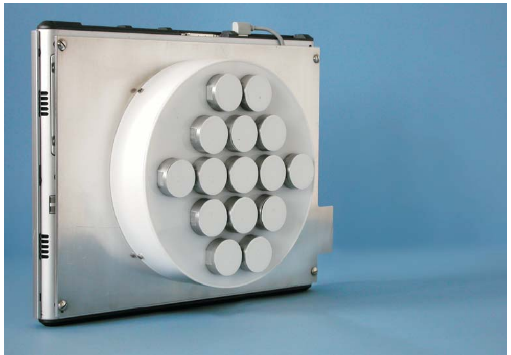
Kontaktloses EKG-System mit Elektrodenarray und Tablet-PC auf der Rückseite
