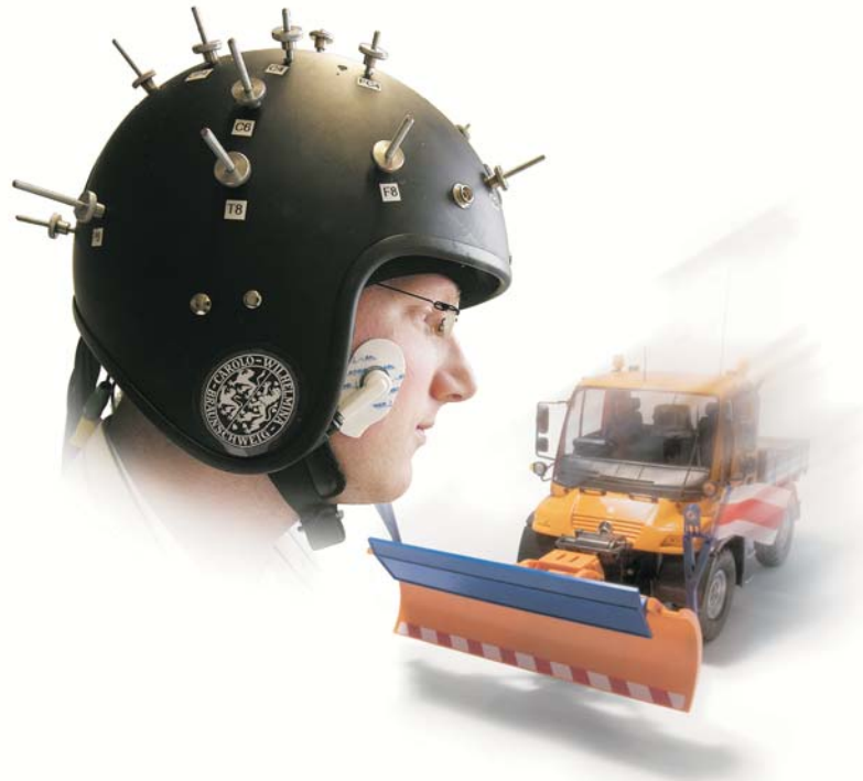
Elektrodenhelm zur Steuerung eines Gerätes, in diesem Fall eines Fahrzeugs
