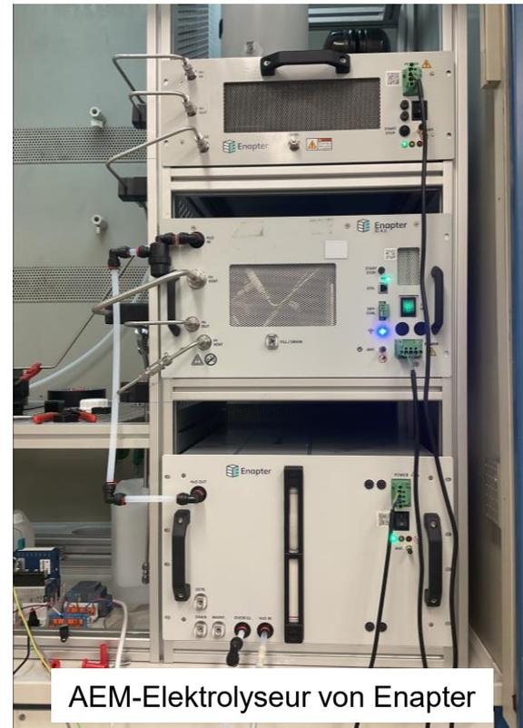
AEM-Elektrolyseur von Enapter
