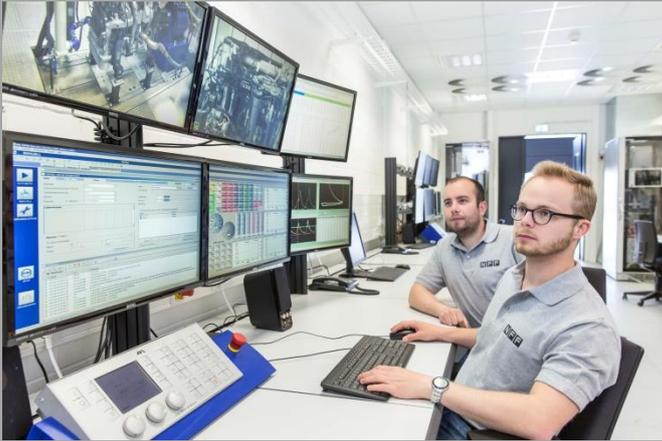
Das Institut verfügt über 16 Motorenprüfstände zur Untersuchung von Benzin-, Diesel- oder Gasmotoren – die Bandbreite reicht vom Einzylinder-Forschungsmotor bis zum Nutzfahrzeugvollmotor.
