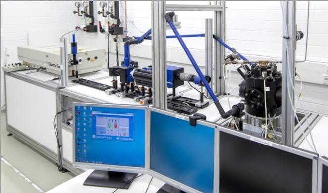
Die optische Untersuchung von Einspritz- sowie Verbrennungsvorgängen werden mit einer optisch zugänglichen Hochdruckkammer durchgeführt. Hierfür stehen 4 optische Zugänge mit einer Durchmesser von 50 mm sowie einem Zugang von 100 mm. Durch die Einstellung von Einspritz- sowie kammerdruck und der Umgebungstemperatur, können Untersuchungen bei unterschiedlichen Bedingungen durchgeführt werden.
