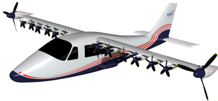
Abbildung 1: X-57 Maxwell, Experimentalflugzeug mit DEP Antriebskonzept [1]
