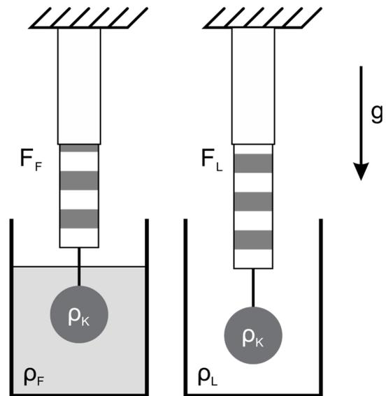
Abbildung 1.1: Auftriebsverfahren zur Dichtebestimmung eines Festkörpers
