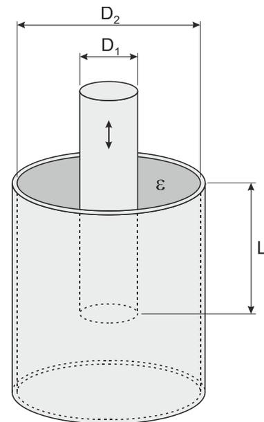
Abbildung 1.1: Prinzipskizze eines Zylinderkondensator
