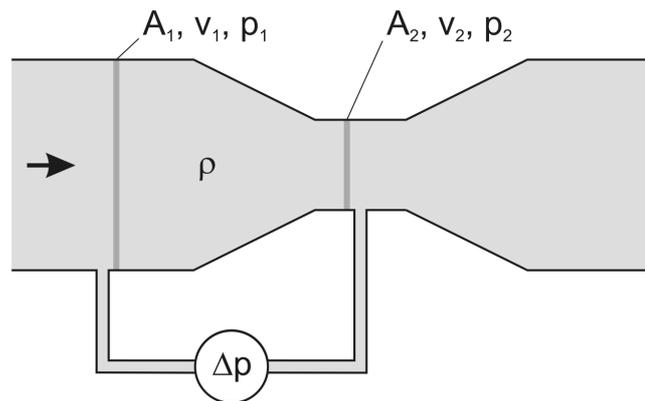
Abbildung 1.1: Prinzipskizze eines Wirkdruck-Durchflussaufnehmers
