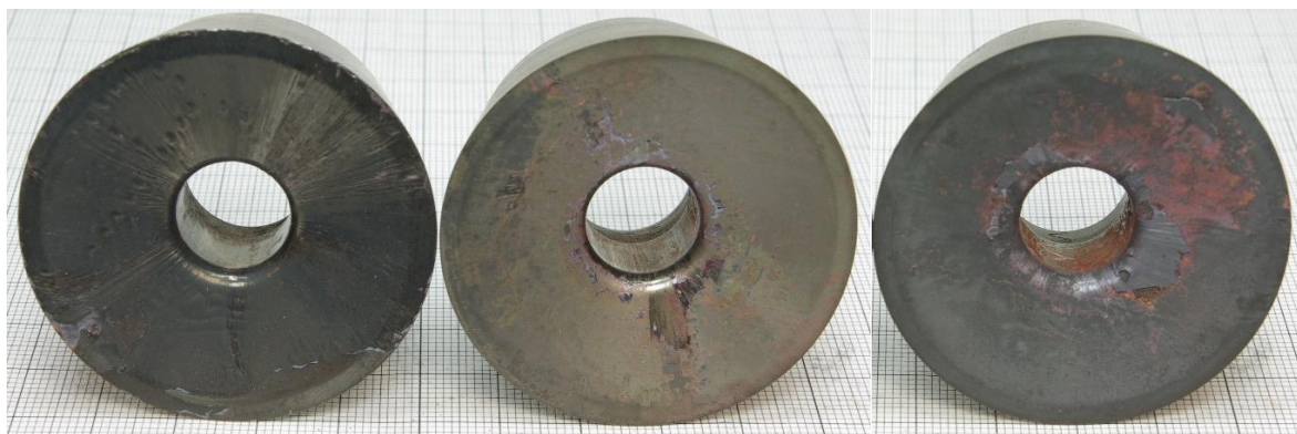
Abbildung 32: Oberflächen bespresster Strangpressmatrizen; 1.2367 unbehandelt mit großflächigen Kupferanhaftungen (links), 1.2367 mit Ti-B-N-Beschichtung (mitte) und 1.2367 mit Ti-Si-B-C-N-Beschichtung (rechts) mit minimal ausgeprägten Anhaftungen
