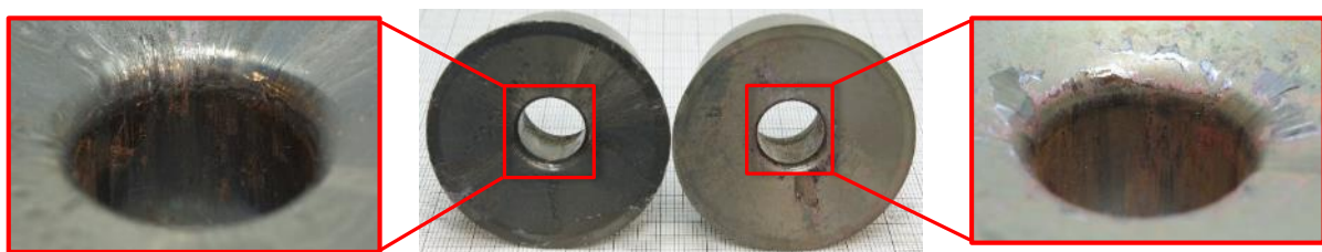
Abbildung 34: Aufnahmen der mit Kupfer bespressten Einsätze: Referenzeinsatz aus unbehandeltem 1.2367 (links) und mit Ti-Si-B-C-N beschichteter Einsatz aus 1.2367 (rechts), jeweils mit Detail des Presskanals.
