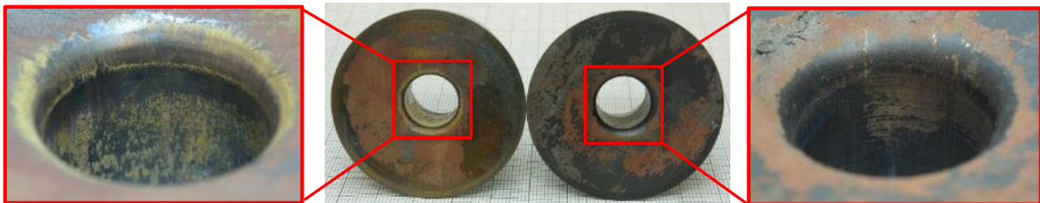
Abbildung 35: Aufnahmen der mit Messing gepressten Einsätze: Referenzeinsatz aus unbehandeltem Stellite 12 (links) und mit bordotiertem \text{Al}_2\text{O}_3 beschichtetem Einsatz aus Stellite 12 (rechts), jeweils mit Detail des Presskanals.
