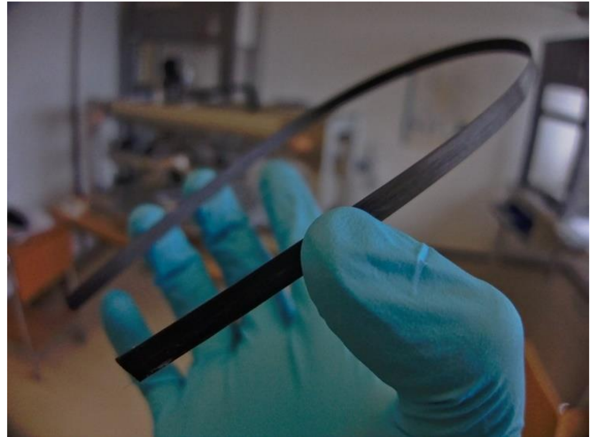
Abb. 1: Ein solches pultrudiertes Bauteil könnte in Zukunft per Self Sensing überwacht werden
