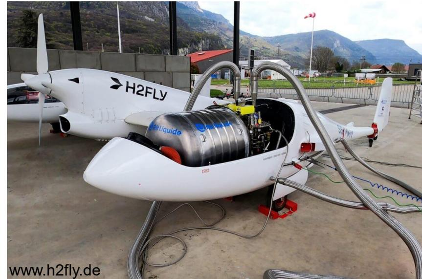
Abb. 1: Flüssigwasserstoff für die Luftfahrt: Flugzeug HY4 der Firma H2FLY
