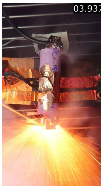
Abbildung: Lithium-Ionen-Batterie beim thermal runaway
