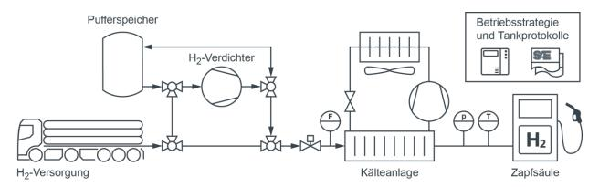
Vereinfachter Aufbau einer typischen Wasserstoff-Tankstelle nach dem Stand der Technik zur Betankung von Pkw mit gasförmigem Wasserstoff bei 700 bar
