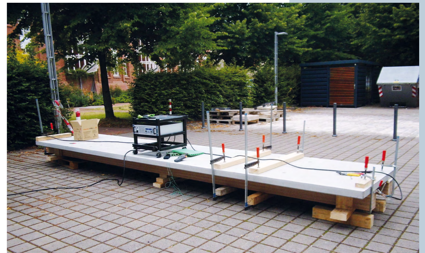
Abbildung 4: Konduktive Schnellklebung im vollen Fertigteilmassstab, Kleblänge 6,15 m als simulierte Baustellenklebung
