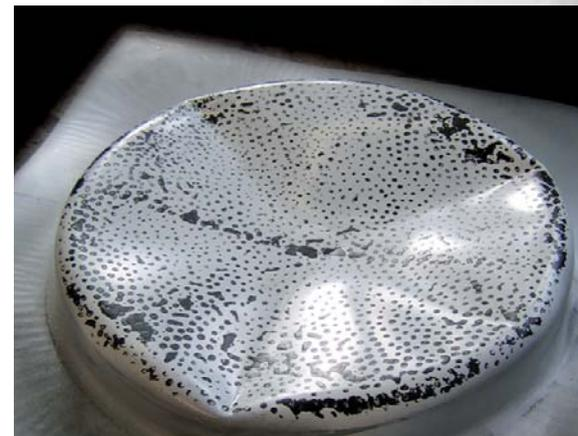
Tiefgezogene Struktur mit regelloser Markierung für Stereogrammetriemessungen
