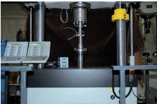
Servohydraulische Prüfmaschine für kombinierte Zug-Druck- und Torsionsbeanspruchung
