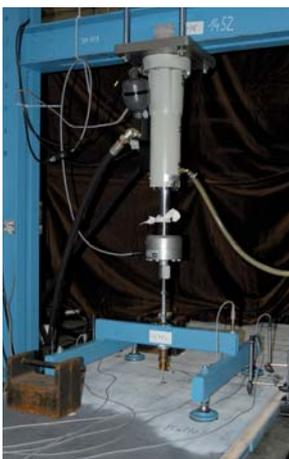
Spannfeld für Schwingfestigkeitsuntersuchungen an Bauteilen und Großproben
