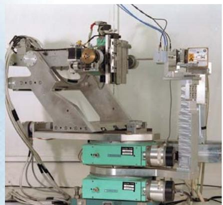
*Ortsfeste Röntgendiffraktometer für Eigenspannungsbestimmungen, Textur- und Phasenanalysen*
