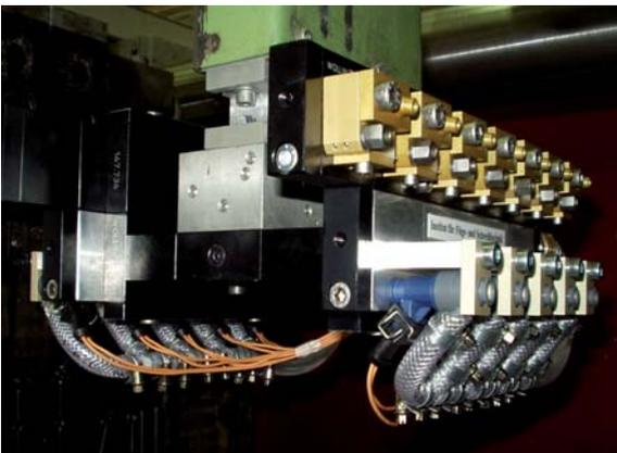
Computergesteuerter Prototyp eines neu entwickelten Sprühkopfes
