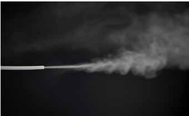
Bild 3: Pulveraustritt aus der Förderleitung (Förderstrecke 3 m, d_{\text{innen}} = 1,7 \text{ mm} )
