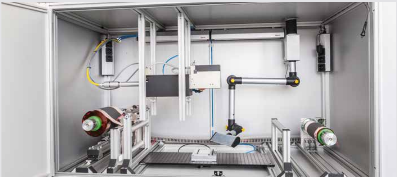
Bild 3: Laserschneidanlage in der BLB
