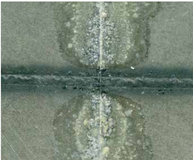
Bild 5: Vergleich des Korrosionsfortschrittes nach 312 h Wechseltest an Laserschweißnähten ohne Nachverzinkung (oben) und mit Nachverzinkung (unten)
