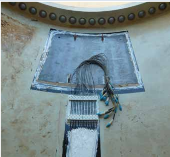
Bild 2: Klebmontage einer Lagerplatte an die beschichtete Wand eines Monopfahls (links) und vollständig angeschlossene Messbox zur autonomen Aufzeichnung der Sensor-Signale während des Pfahl-Rammvorgangs (rechts)
