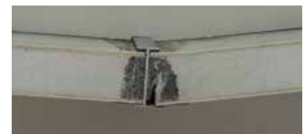
Bild 3: Geprüfte Sandwichproben – oben Versagen der Fügestelle, unten Versagen durch Eindringen der Deckschicht in den Schaumkern
