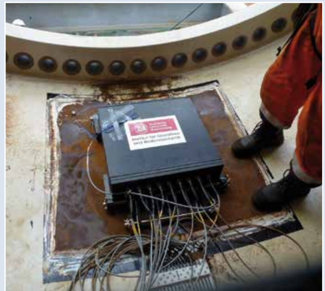
Bild 2: Klebmontage einer Lagerplatte an die beschichtete Wand eines Monopfahls (links) und vollständig angeschlossene Messbox zur autonomen Aufzeichnung der Sensor-Signale während des Pfahl-Rammvorgangs (rechts)
