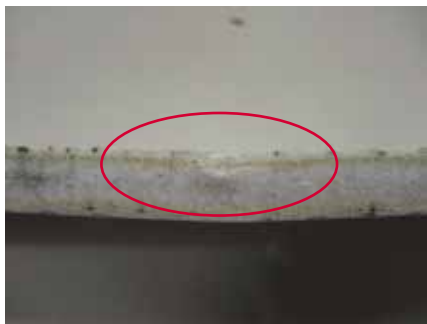
Bild 5: Versagen der Sandwichproben – oben Versagen durch Eindrücken des Sandwichs an der Krafteinleitung, unten Versagen durch Einknicken des Sandwich und Bruch der Deckschicht
