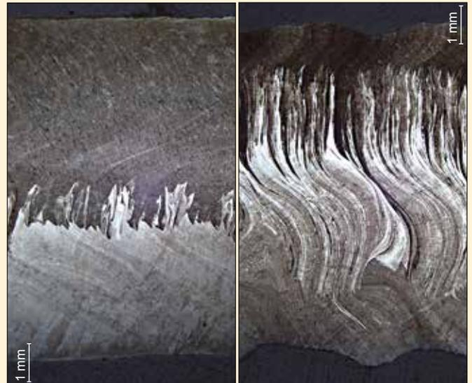
Bild 4: Veränderung der Schmelzbadynamik in Abhängigkeit vom Druck (links: 1000 mbar; rechts: 10 mbar) ( $P = 4750 \text{ | } 2750 \text{ W}$ ;  $v = 0,5 \text{ m/min}$ ;  $z_F = -4 \text{ mm}$ )
