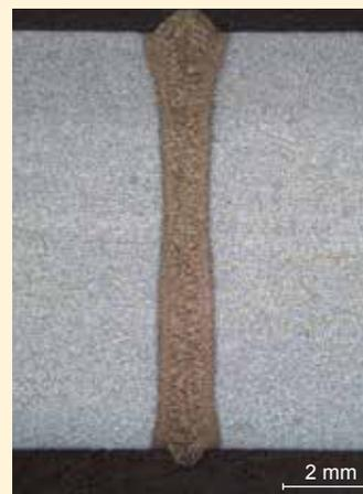
Bild 2: Querschliff einer hochqualitativen Schweißung im Unterdruck bei 10 mbar (P = 6000 W; v = 2,0 m/min; zF = -4 mm)
