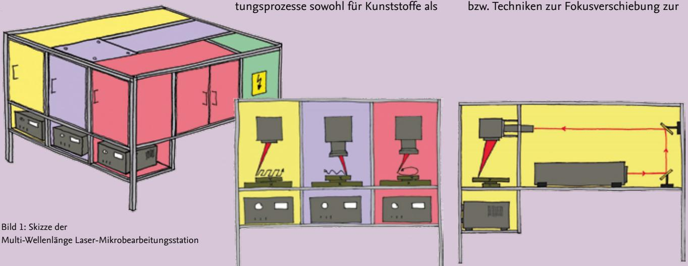
Bild 1: Skizze der Multi-Wellenlänge Laser-Mikrobearbeitungsstation
