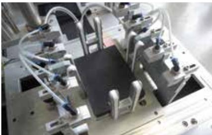
Bild 2: Gestapelte Elektrodenfolien in einem Magazin
