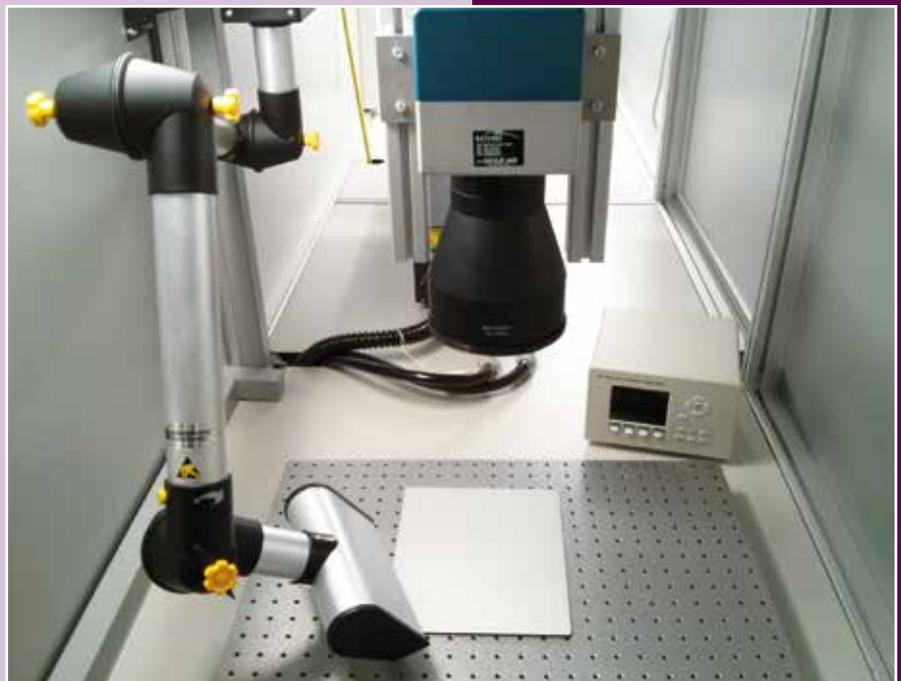
Bild 3: Bearbeitungskammer und Strahlengang für die Metallbearbeitung (Laserquellen mit 532 und 1064 nm).
