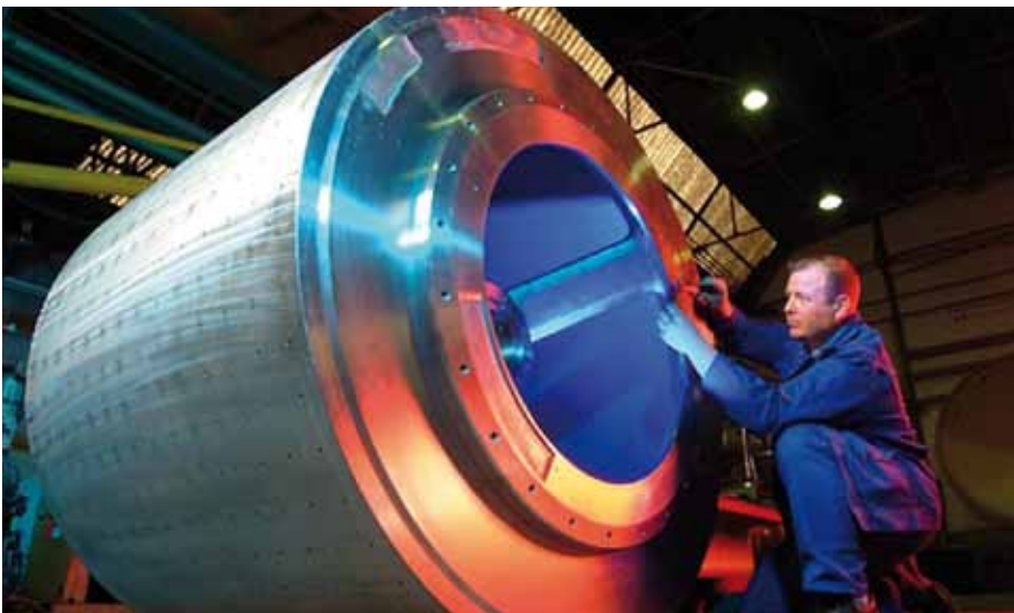
Zentrifugentrommel aus 1.4462 Quelle: BMA Braunschweiger Maschinenbauanstalt
