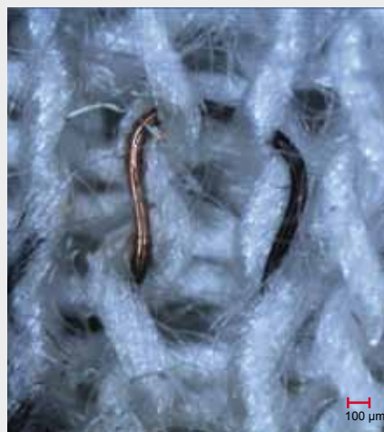
Abb. 3: Im linken Bereich abisolierter Kupferlackdraht. Im rechten Bereich nicht bearbeiteter schwarzer Kupferlackdraht.
