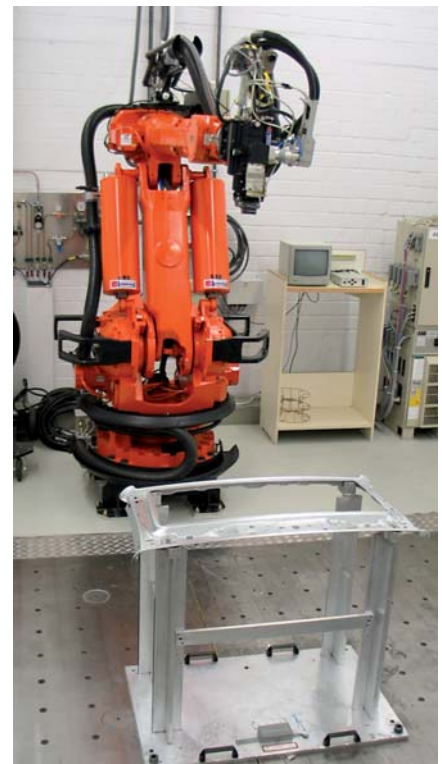
Abb. 3: Dachteil in Hybridfügetechnik
