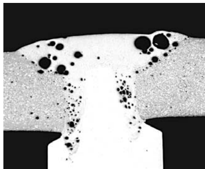
Abb. 3: EB-Schweißung mit Mehrstrahltechnologie, Verbindung Knetlegierung / Druckgusslegierung
