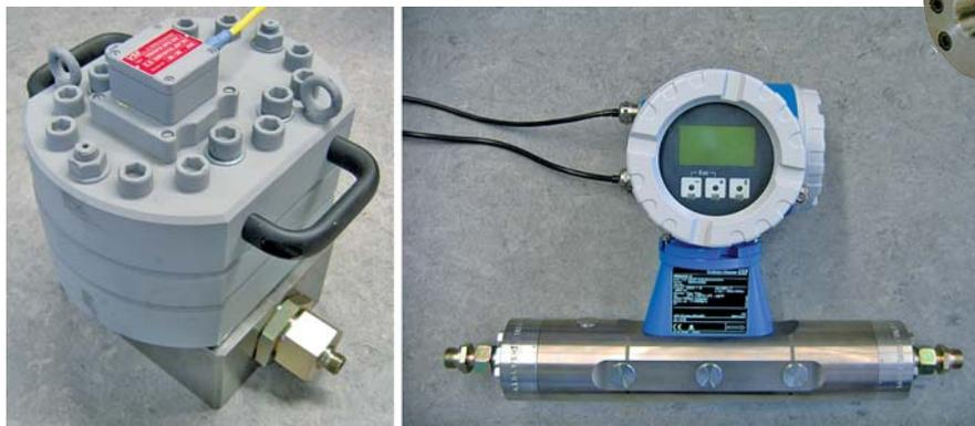
Durchflussmesszellen (links Zahnradmesszelle; rechts Coriolismesszelle)
