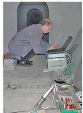
Einrichten einer Messstation zur Bauwerksüberwachung im Hauptträger der Brücke A2 über den Mittellandkanal bei Braunschweig.
