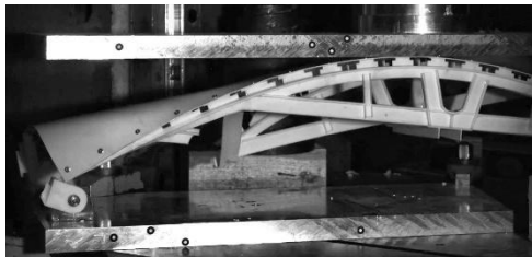
Abbildung 1: Spantsegment im Fallturm
