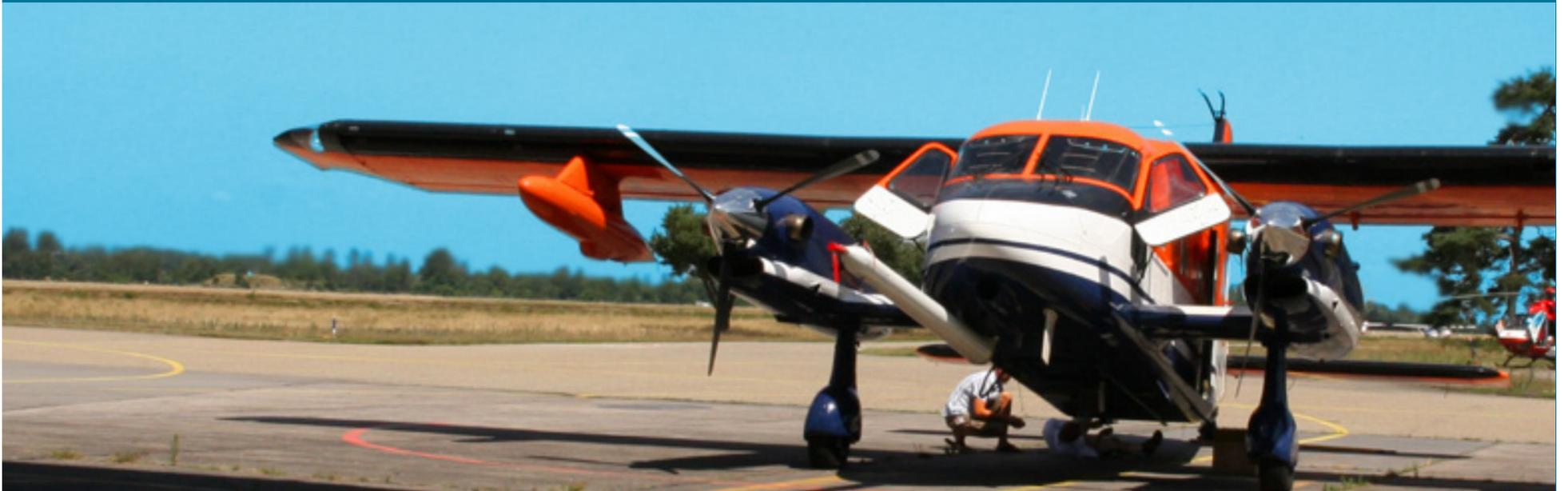
Das Institut für Flugführung (IFF) der TU Braunschweig betreibt das Forschungsflugzeug D-IBUF und die Hubschrauber-Schleppsonde Helipod. Für meteorologische Messungen ist es wichtig, schnell und genau Feuchtemessungen durchzuführen. Bisher wurde dafür ein Lyman-Alpha-Gerät eingesetzt, für das jedoch kein Ersatz mehr verfügbar ist.
