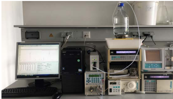
Experimenteller Aufbau für die dynamischen Methoden mittels HPLC-System
