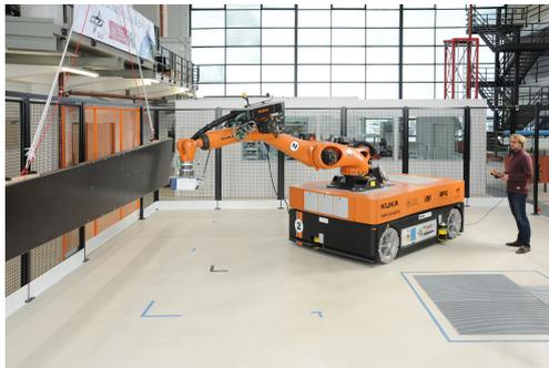
*mobile Roboterplattform - KUKA KMR Quantec*
