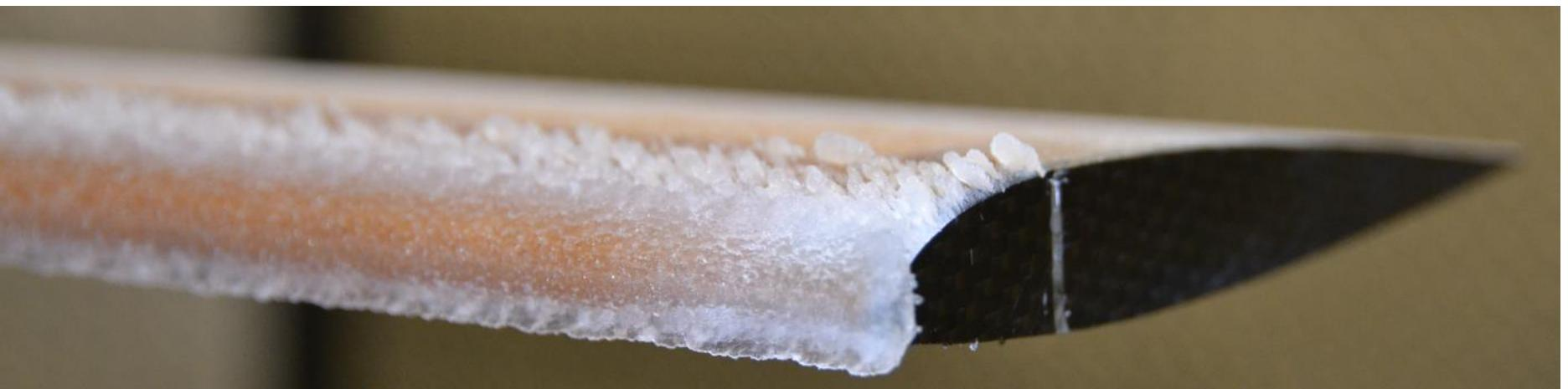
In einem im Umbau befindlichen Rotorturm werden atmosphärische Vereisungsbedingungen nachgestellt, um neue vielversprechende Eiserkennungs- und Eisschutzsysteme für Hubschrauber zu erproben. Für die Erfassung der momentanen Eisschichtdicke im Rotorblattnasenbereich während des Vereisungsprozesses soll das Rotorblatt eine Lichtschranke passieren, deren Unterbrechungsdauer Aufschluss über die Länge in Richtung Profiltiefe und damit die Eisschichtdicke Aufschluss gibt.
