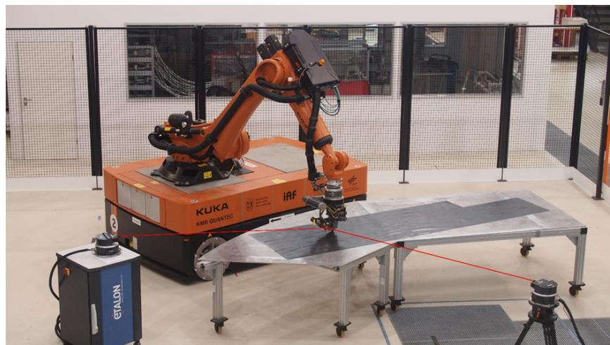
*mobile Roboterplattform - KUKA KMR Quantec mit Etalon LaserTRACERn*
