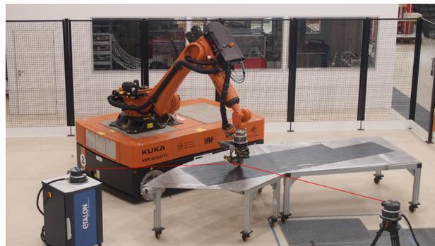
*Mobile Roboterplattform - KUKA KMR Quantec mit LaserTRACERn*
