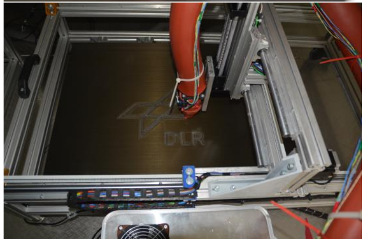
→ Abbildung 5: Draufsicht auf den Eisdruckprozess. Hier: Druck des DLR-Logos.
