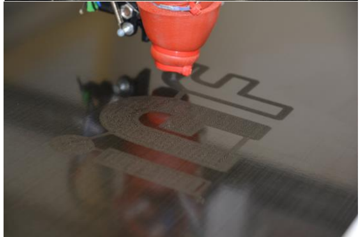
→ Abbildung 4: Abscheidung eines Tropfennebels aus der Düse (rot) am Beispiel des iAF-Logos.
