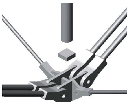
Bild 14. Detail der Anschlussstechnik des Zugstabsystems (Foto: osd - Ingenieure)
