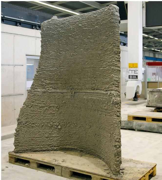
**Bild 11** Am ITE im Shotcrete 3D Printing (SC3DP)-Verfahren hergestelltes Wandelement
