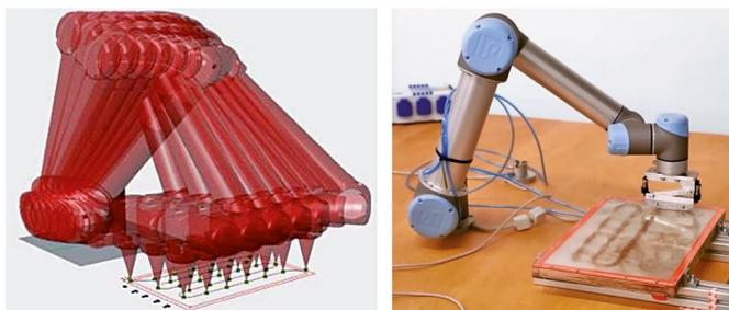
**Bild 3** Offline-Simulation (links) und kleinmaßstäbliche Laborversuche zur roboterassistierten magnetischen Ausrichtung von Stahlfasern, Video veröffentlicht auf [www.ite.tu-bs.de](http://www.ite.tu-bs.de) (rechts)
