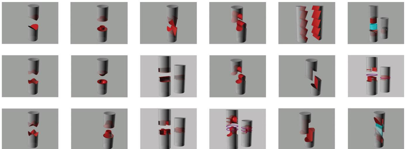
**Bild 5** Typologische Entwicklung von neuartigen Konstruktionsprinzipien für trockene Stoßverbindungen von rohrförmigen Stäben
