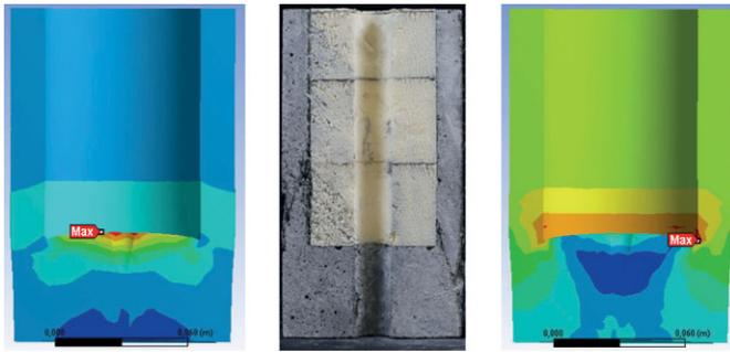
**Bild 9** Max. Hauptspannungen (links), Bruchbild Probe (Mitte), Maximale Schubspannungen (rechts) (Zylindergeometrien)
