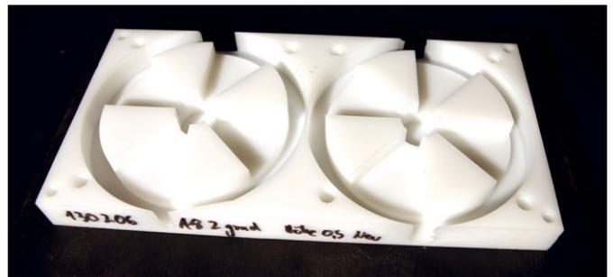
**Bild 11** Stirnplattenschalung aus CNC gefrästem Polyoxymethylen (POM) zur Formung des Trockenstoßbereichs
