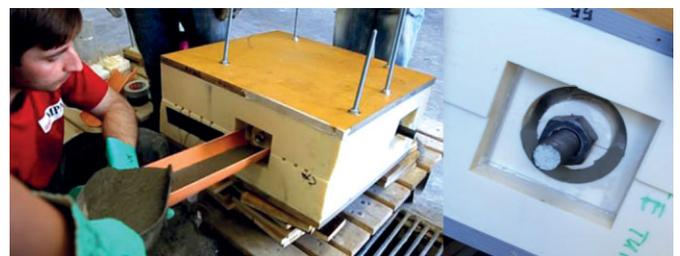
**Bild 20** Betonierung des Knotens (links)/optische Kontrolle der Steighöhe (rechts)
