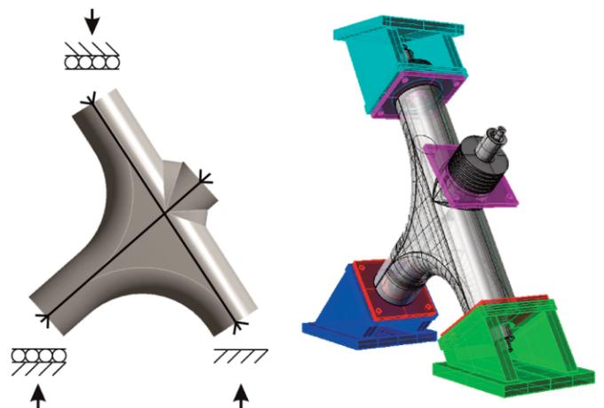
**Bild 22** Versuchsaufbau der Knotenprüfung in der Druckprüfmaschine, schematisch mit konstanter Vorspannung (links) und Ansicht mit Auflagern (rechts) [L. LEDDEROSE]
