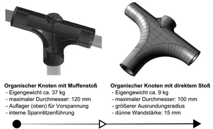
**Bild 17** Knotenentwicklung: organischer Knoten mit Vorspannung und Muffenstoß (links), gewichtsoptimierter organischer Knoten mit direktem Stoß (rechts)
