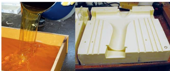
**Bild 18** Außenschalung des Knotens bestehend aus Wachs
