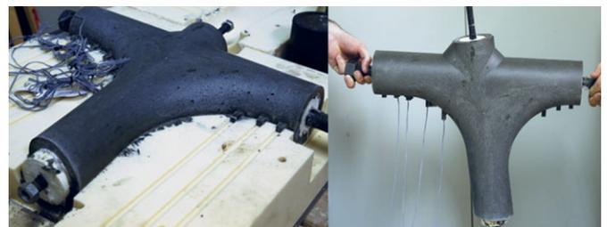
**Bild 21** Ausschalen des Knotens (links)/leichter UHPFRC-Knoten (rechts)
