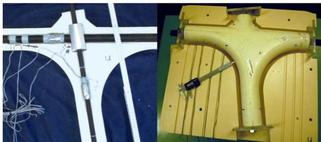
**Bild 19** Polystyrol Innenkern mit Spanngliedern (links)/in Außenschalung (rechts)
