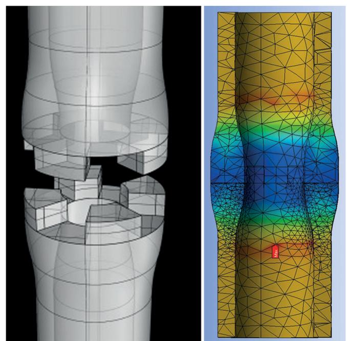
**Bild 14** Stoßserie A12 mit symmetrischer Aufweitung CAD Zeichnung (links)/ Maximale Schubspannungen (rechts)
