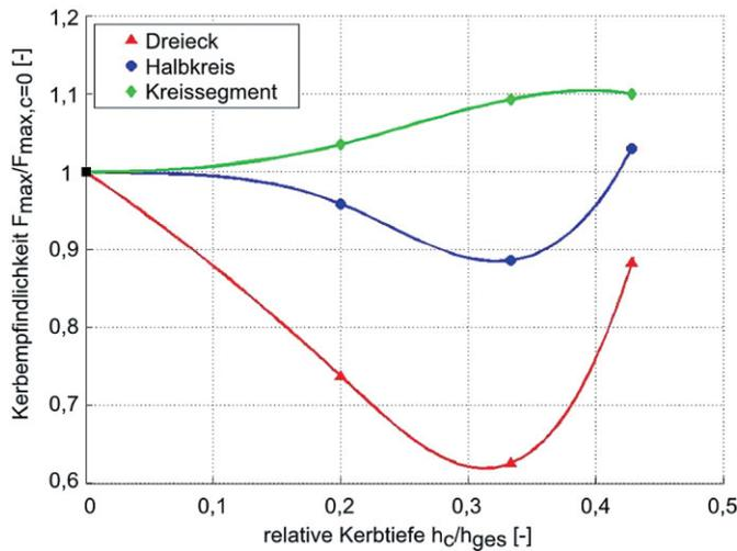
**Bild 4** Kerbpfindlichkeit in Abhängigkeit von der Kerbgeometrie des UHPFRC FK1-2,5
