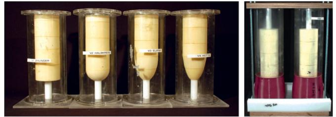
**Bild 10** Versuchskörper: zusammengesetzte Schalungen für Krafteinleitungsbereiche (links) und Stoßbereiche einschl. Schalungsteile aus FDM (Fused Deposition Modeling) (rechts)
