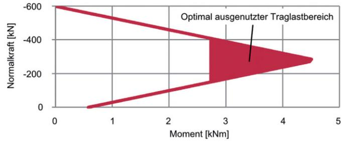
**Bild 15** Linearelastische Momenten/Normalkraft Interaktion vom verwendeten Rohrquerschnitt
