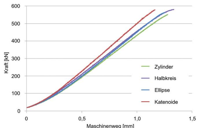
**Bild 8** Kraft-Weg-Diagramm der UHPFRC-Rohre mit verschiedenen Übergangsgeometrien im Kräfteinleitungsbereich zum Vollquerschnitt (Versuchsserie 1)
