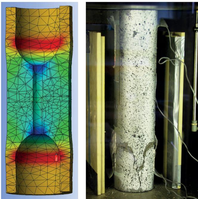
**Bild 13** Maximale Schubspannungen Stoßserie A8 (links) im Vergleich zu den geprüften Versuchskörpern (rechts)
