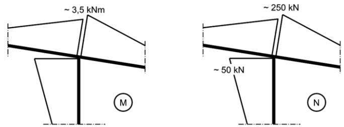
**Bild 16** Statische Anforderung an das Knotenelement im Rahmentragwerk anhand der Tragfähigkeit der untersuchten Stabgeometrie
