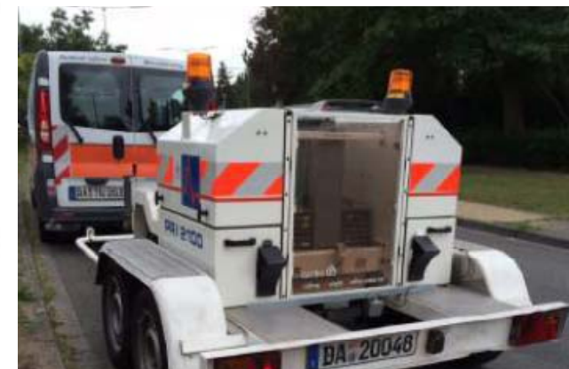
Vergleichsmessungen mittels Falling-Weight-Deflectometer (FWD)
