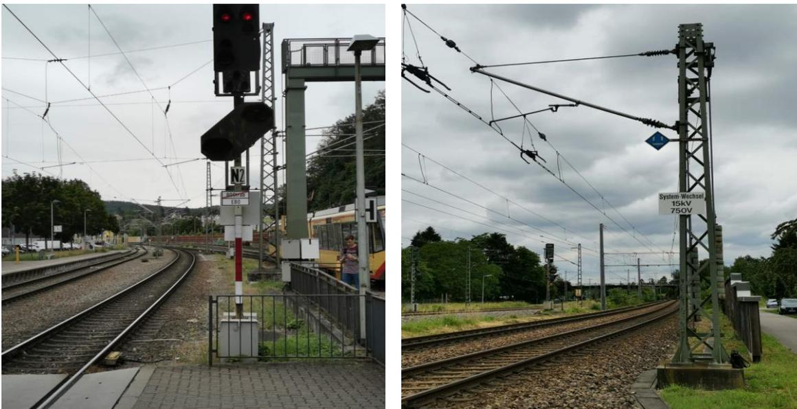
**Abbildung 7. Knotenpunkt von EBO und BOStrab (links) und Systemwechselstelle (rechts).**
