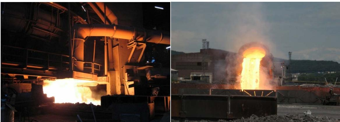
Abbildung 15. Der Hochofen im Stahlwerk (li.), Flüssige Schlacke beim Abgießen in die Beete (re.)
