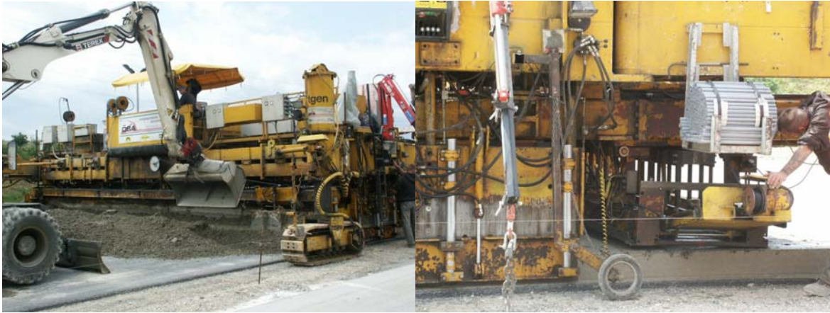
Abbildung 16. Betonfertiger (li.), Detail (re.).
