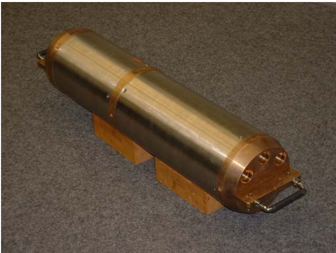
Abb. 1: Druckfeste Kapselung (ohne Fahrge- stell). Vorne drei Gewinde für Datenschnitt- stellen zur Infrarot-Übertragung durch drei Schraubschaugläser (nicht sichtbar).
