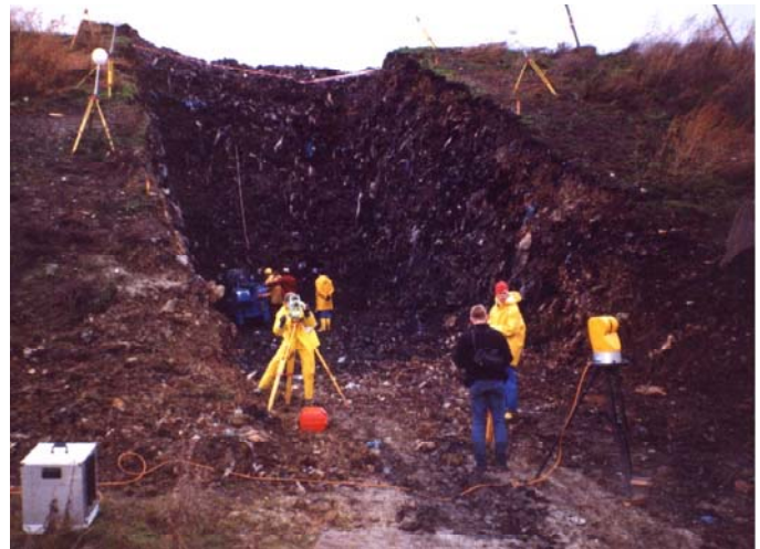
Abb. 2: Laserscanning während der Bepro- bung am Schurf Deiderode (Zentraldeponie Göttingen). Vordergrund, rechts: CALLIDUS Laserscanner des Büros Dipl.-Ing. Mittelstädt und Schröder, links Leica TCRM 1103 Ta- chymeter. In der Böschung ist eine Passku- gel zu erkennen, Hintergrund, links: Bohrung und Verlegung eines Messrohres
