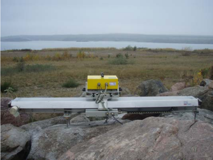
Abbildung: 1 Testmessungen mit dem GBSAR-System IBIS-L im Tagebau Greifenhain
