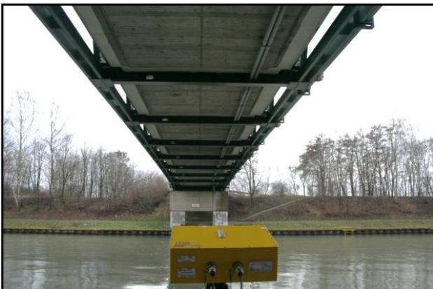
Abbildung 4: Blickrichtung des Sensors unter der Brücke. Die Querträger aus Stahl wirken als Corner Reflektoren (Riedel und Lehmann, 2012).
