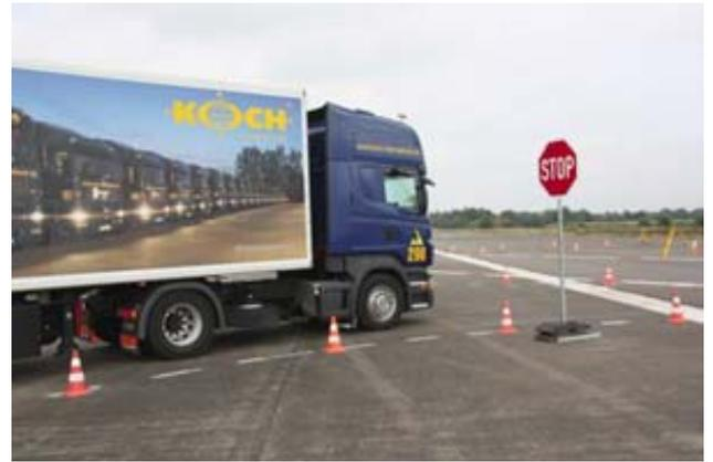
Abbildung 9: Testszenario zur Erfassung der Schleppkurven
