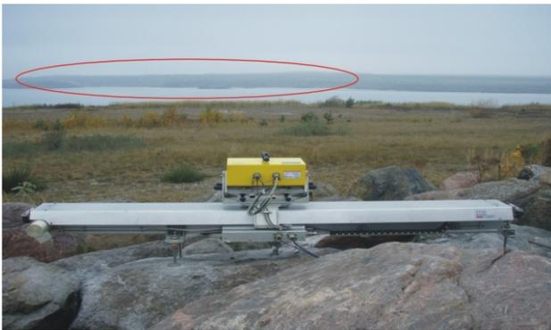
Abbildung 6: Das eingesetzte GBSAR-Messsystem im Tagebaurestloch Greifenhain, innerhalb der Ellipse befindet sich der instabile Böschungsabschnitt.
