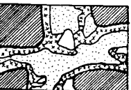
Bild 2 : Stufenmodell zur Gefügeverfestigung von PCC nach OHAMA [45]
